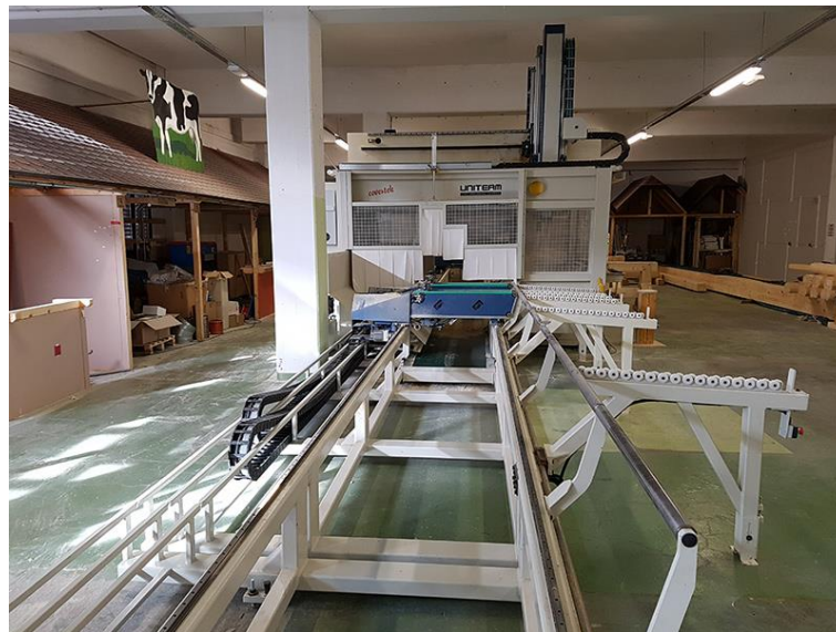
Slika 9: CNC-stroj za razrez lesa s podajno mizo
