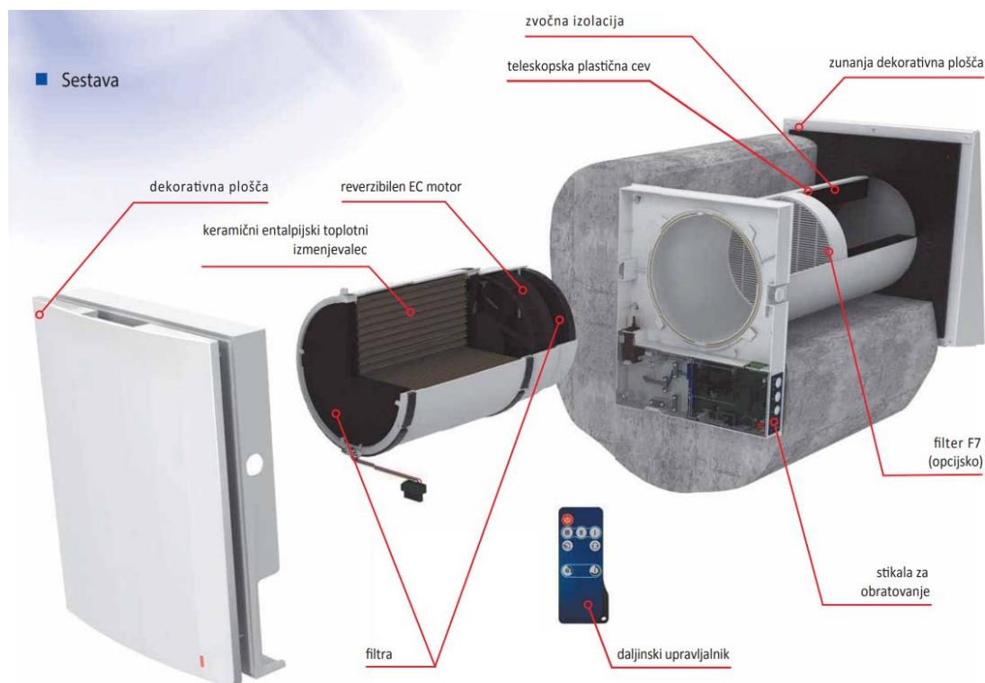
Slika 10: Prerez sestave lokalne prezračevalne naprave z rekuperatorjem
