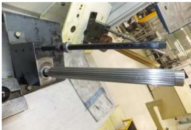
Slika 11: Konični kaliber pri posnemanju
