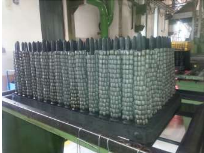
Slika 12: Pripravljen material za termično obdelavo
