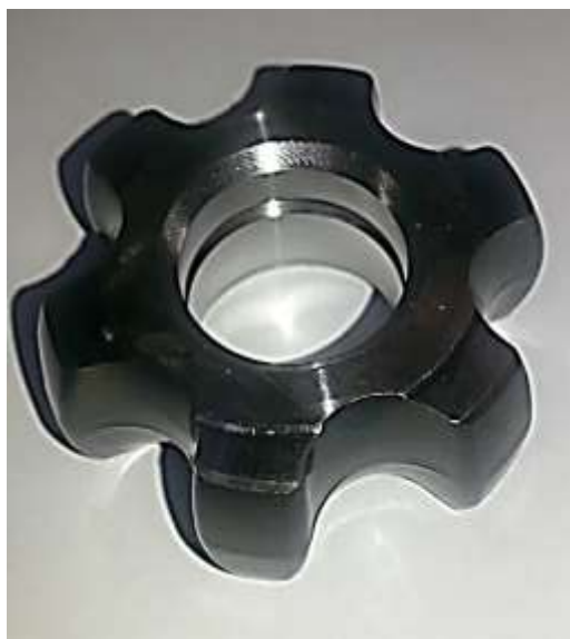
Slika 9: Pesta s postruženo izvrtino in utorom
