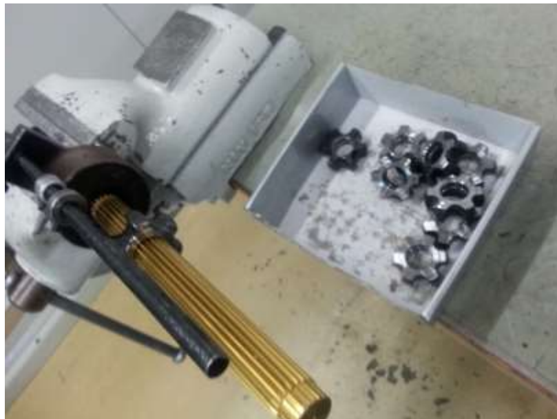
Slika 27: Meritve na koničnem kalibru po termični obdelavi
