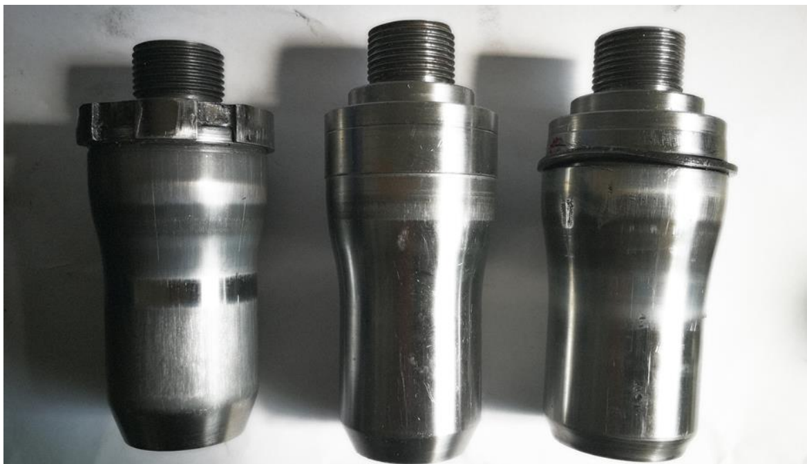
Priloga 2: Fotografija obdelovancev pred in po vtiskovanju ter končni struženi izdelek z napako.
