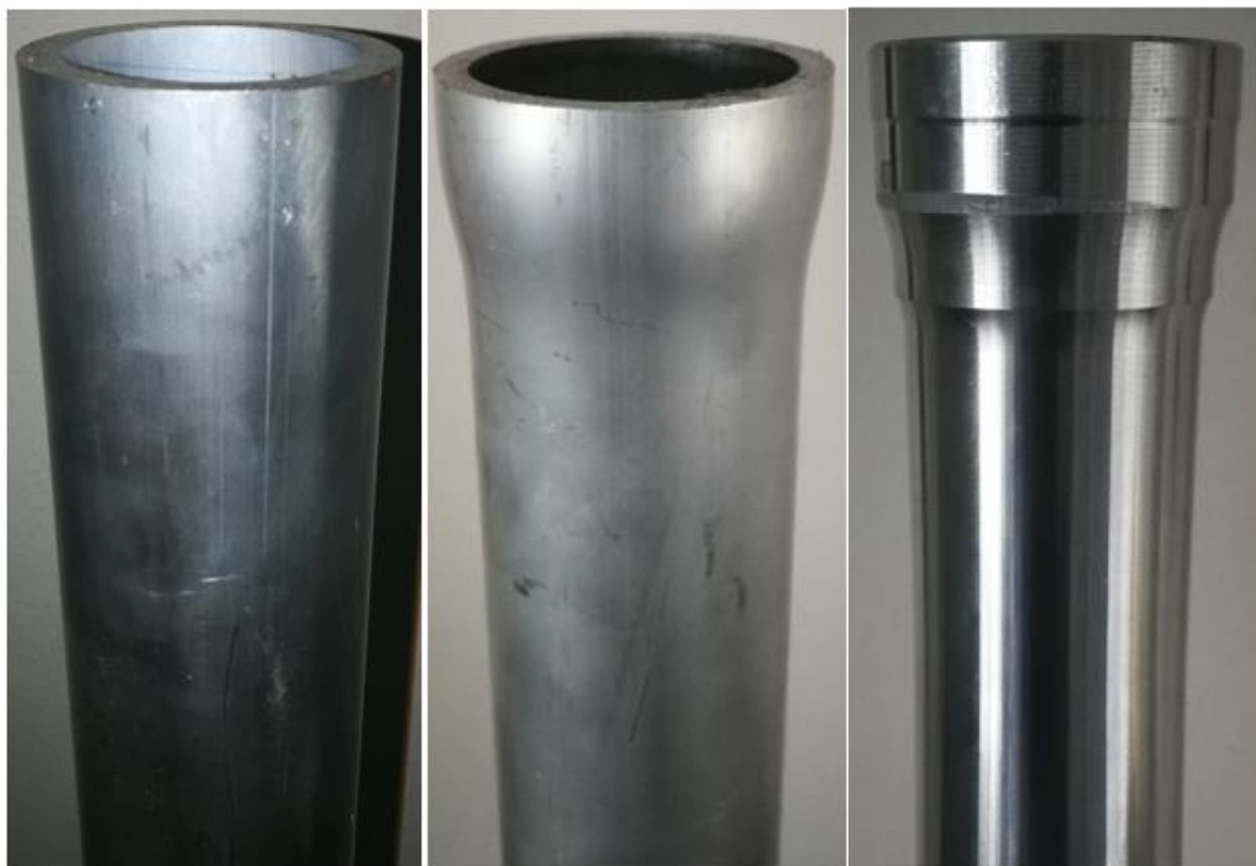
Priloga 2: Fotografija obdelovancev pred in po vtiskovanju ter končni struženi izdelek z napako.
