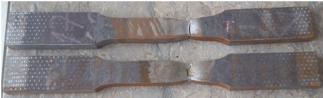
Slika 24: Vzorca nateznega preizkušanja po testiranju
