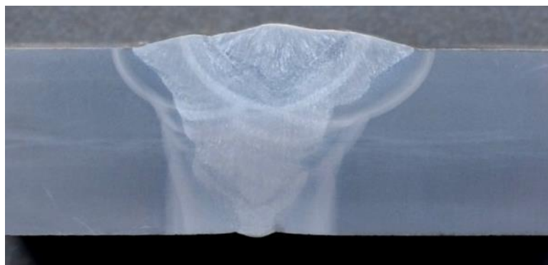
Slika 11: Makro obrus vzorca debeline 15 mm
