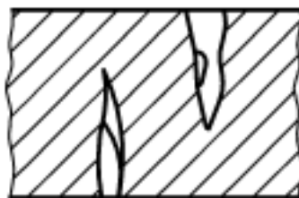
Slika 6: Primer zarez na površini reza zaradi nečistoč
