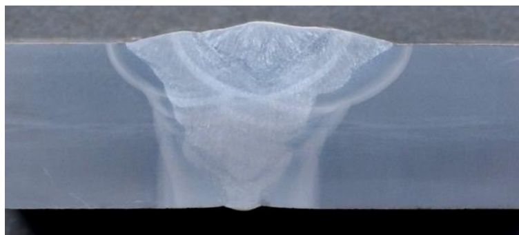
Slika 35: Fotografija makroskopske preiskave obrusa EN ISO 17639 – A – E – 22.2 – 22.2 / Nital
