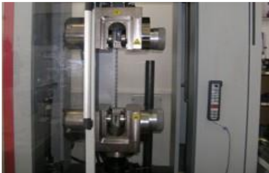
Slika 25: Vpenjalne čeljusti univerzalnega stroja za natezne preizkuse, na katerem je bil preizkus opravljen
