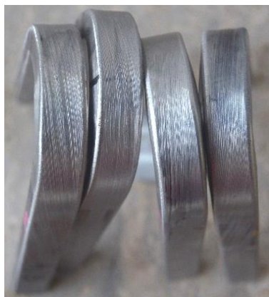
Slika 28: Upognjeni vzorci po preizkušanju
