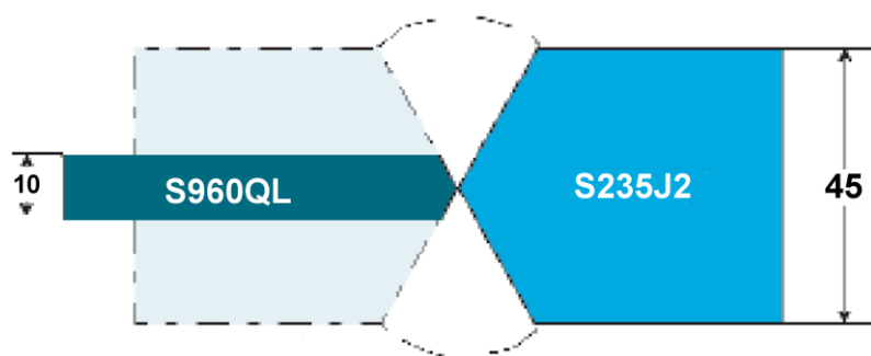
Slika 3: Primerjava uporabe materiala S235 in visokotrdnostnega finozičnega S960QL
