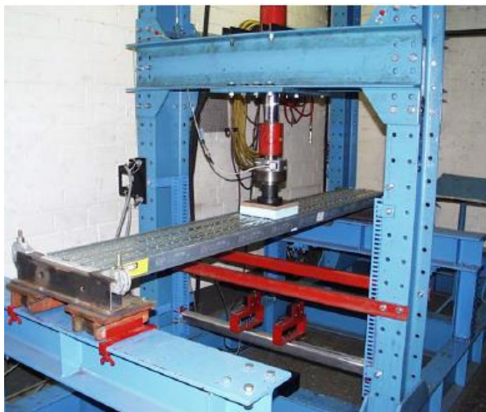
Slika 77: Prikaz preizkusa točkovne obremenitve elementa
