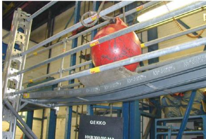
Slika 73: Prikaz padnega preizkusa gradbenega odra
