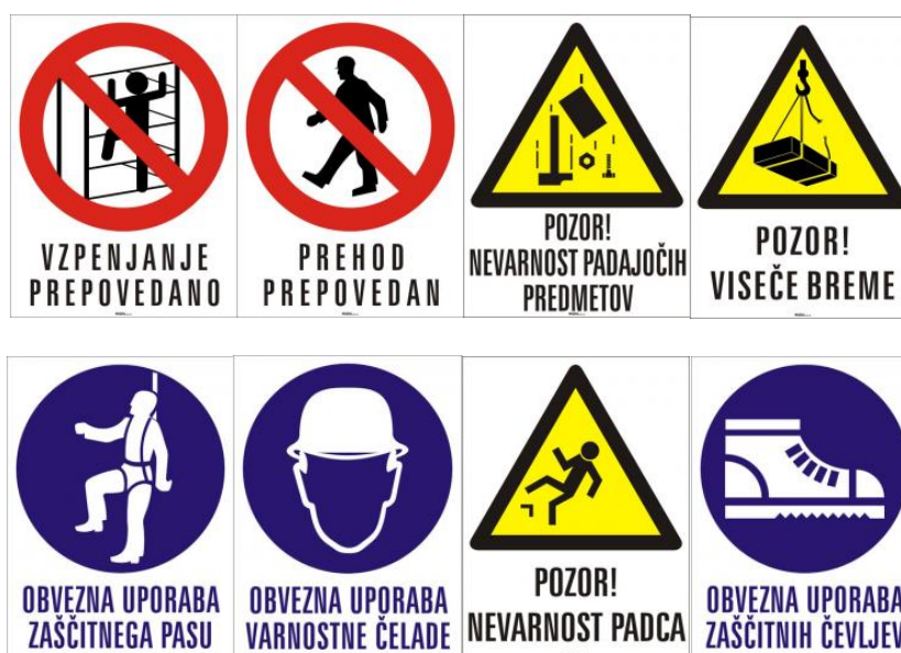
Slika 86: Primeri opozorilnih znakov na gradbišču
