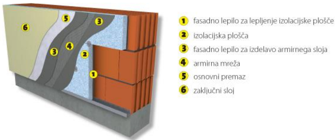
Slika 1: Sestava Klasične – kontakne fasade
