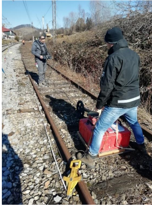
Slika 11: Kalibracija oddajno sprejemne antene
