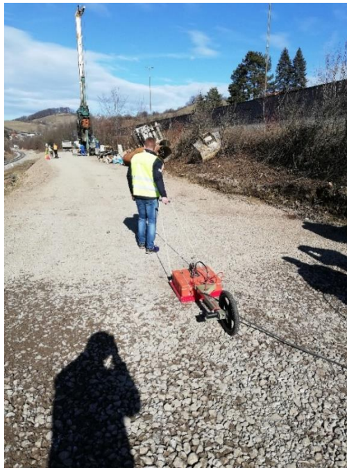
Slika 12: Posnetek terena z oddajno sprejemno anteno
