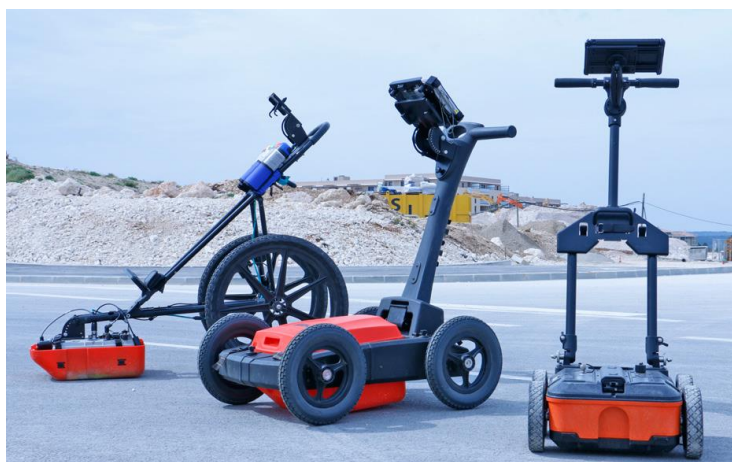
Slika 1: Oprema georadarske metode GPR
