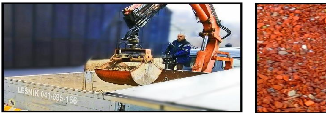
Slika 19: Kamion s hidravličnim dvigalom; opečni granulati
