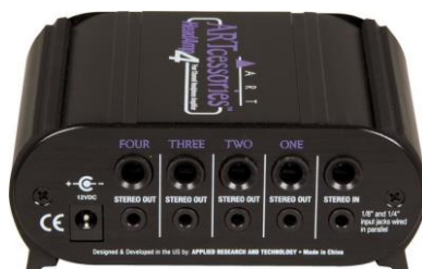
Slika 15: 4-kanalna ojačevalna enota za slušalke ART HeadAmp 4
