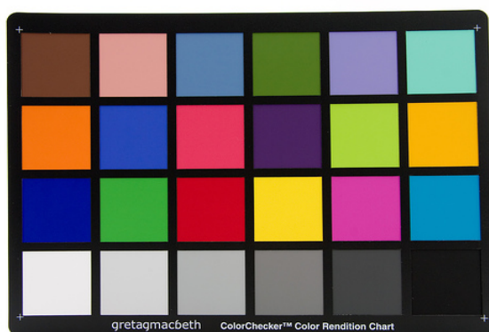
Slika 23: Barvna skala, pripomoček za pravilno nastavitvev beline na fotoaparatu
