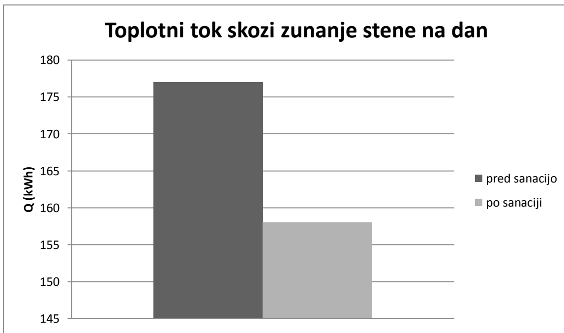
Grafikon 1: Toplotni tok skozi zunanje stene na dan
