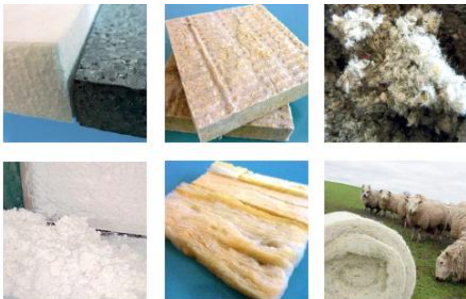
Slika 6: Ekspandirani polistiren, kamena volna, celulozni kosmiči, leseni kosmiči, steklena volna, ovčja volna
