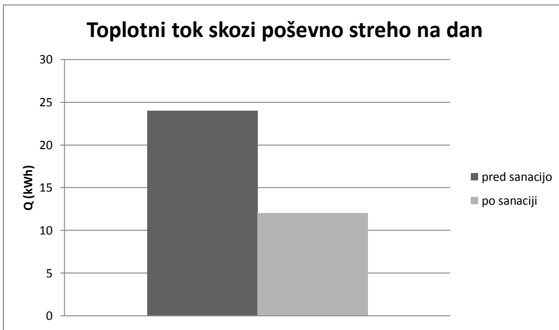
Grafikon 3: Toplotni tok skozi poševno streho na dan
