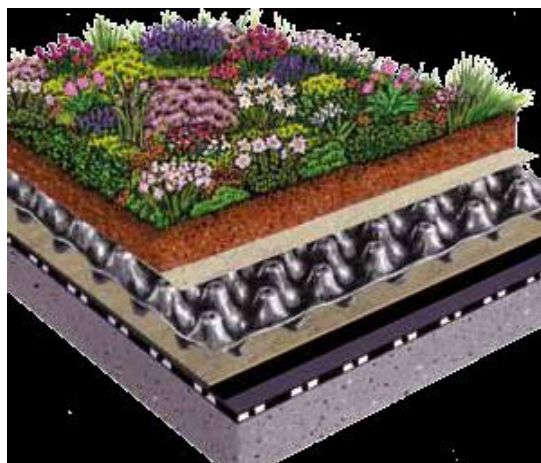
Slika 38: Ekstenzivna ozelenitev v prerezu Vir: http://www.zinco.de/ , 21.10.2012
