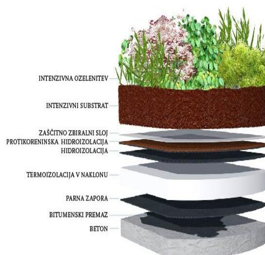
Slika 43: Topla ravna zelena streha - intenzivna ozelenitev
