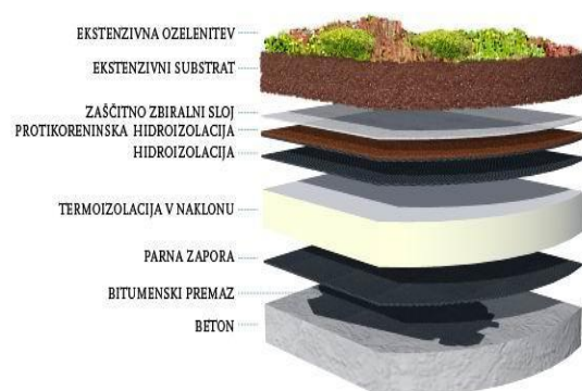
Slika 42: Topla ravna zelena streha - ekstenzivna ozelenitev
