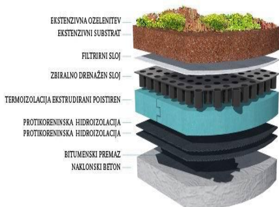
Slika 44: Obrnjena ravna zelena streha ekstenzivna ozelenitev
