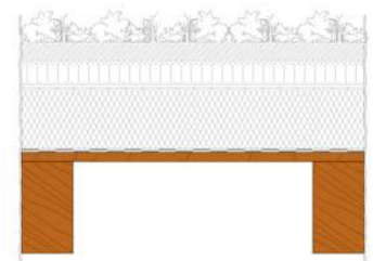
Slika 16: Lesena konstrukcija Vir: http://dkum.uni-mb.si/Dokument.php?id=18442,30.10.2012
