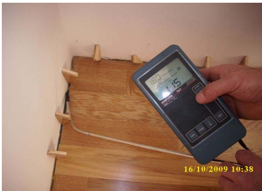
Slika 3: Merjenje količine uhajanja zraka z anemometrom
