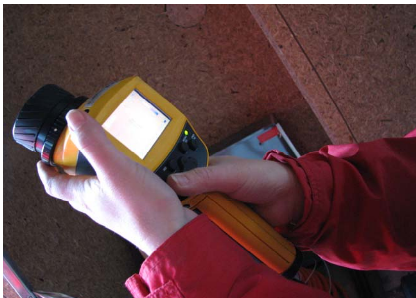
Slika 22: Odkrivanje uhajanja zraka s termovizijskim aparatom
