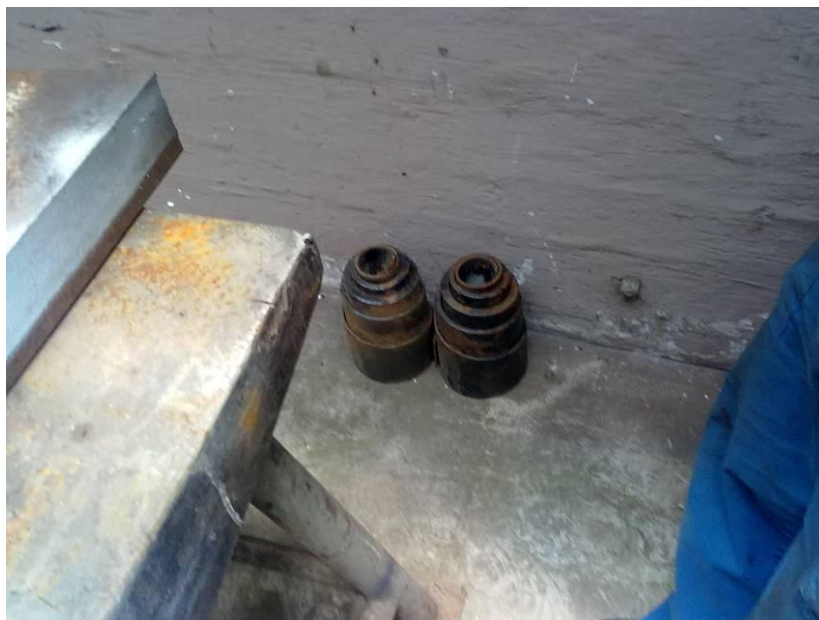
Slika 22: Vijčne listnate vzmeti protivodilnih koles
