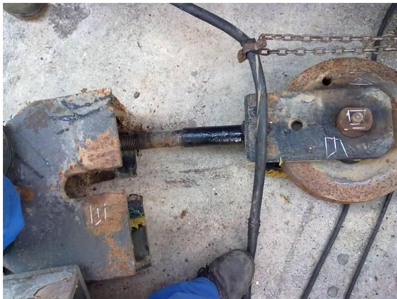
Slika 23: Primer razstavljenega protivodilnega kolesa
