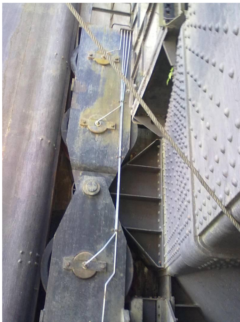
Slika 28: Mazalni vodi iz nerjavnih cevi
