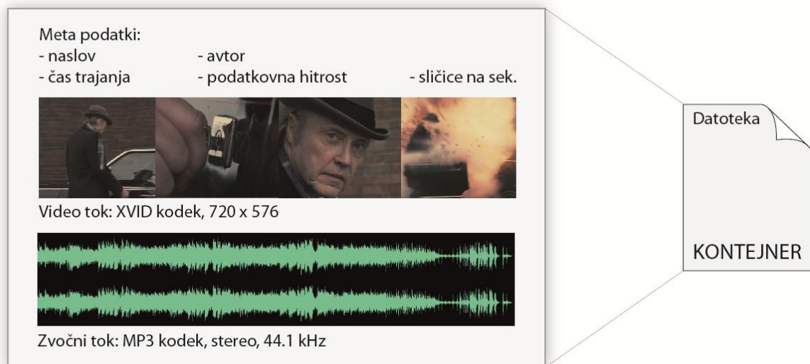
Slika 3: Primer datotečnega kontejner formata z enim zvočnim in enim video tokom
