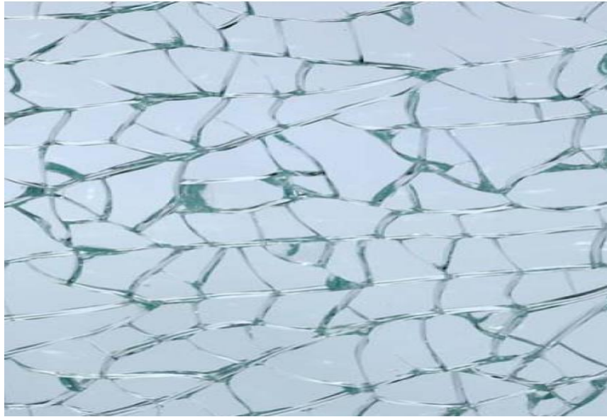
Slika 8: Struktura loma kaljenega stekla
