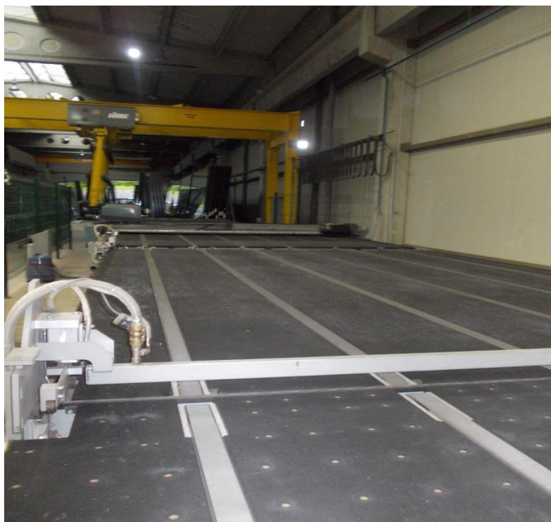
Slika 31: Rezalna miza Lisec, v ozadju nakladalka Lisec
