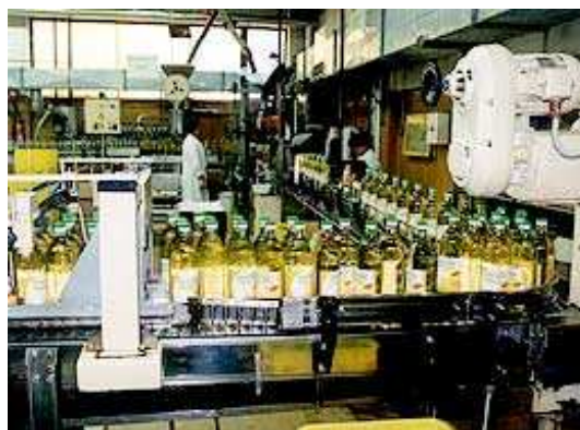
Slika :2. Polnilna linija steklene embalaže( www.gea.si )
