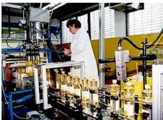
Slika :1. Polnilna linija plastične embalaže( www.gea.si )
