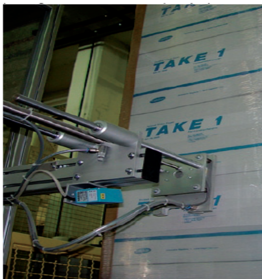
Slika 4: Avtomatsko lepljenje logistične etikete na paleto
