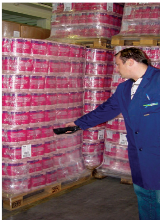
Slika 6: Scaniranje logistične nalepke z ročnim terminalom v skladišču
