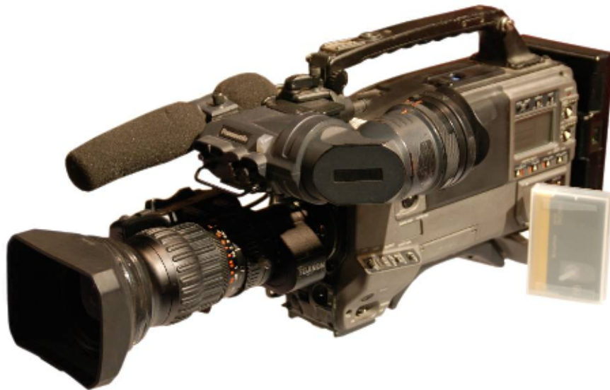
Slika 2: Kamera z možnostjo zapisovanja slike in tona na magnetni trak, vir: lasten
