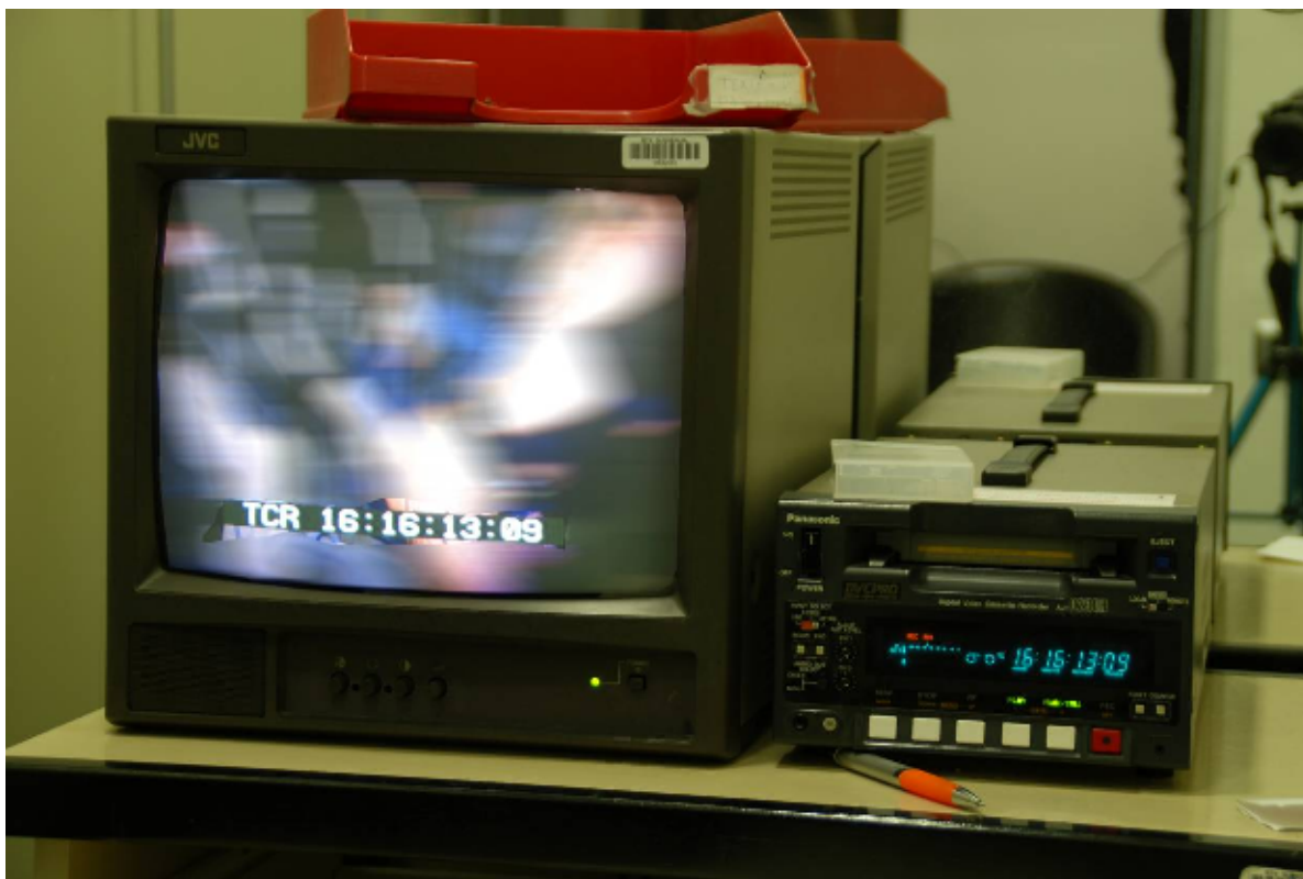
Slika 5: Pregledovalnica opremljena za format (DVC-Pro in DV format), vir: lasten
