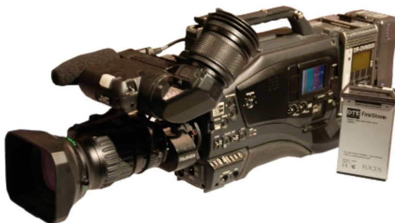
Slika 8: Kamera za terensko snemanje, zapisuje sliko in ton na trdi disk, vir: lasten
