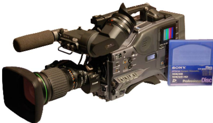
Slika 9: Kamera za terensko snemanje, zapisuje sliko in ton na optični disk, vir: lasten
