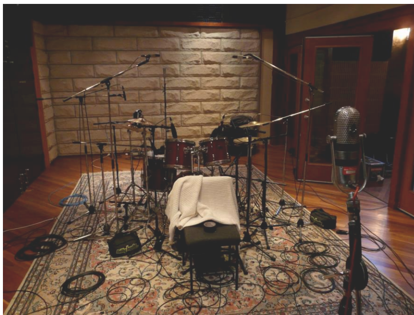
Slika 2: Primer postavitve mikrofona za bobne
