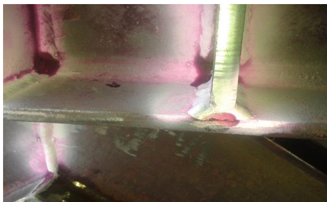
Slika 9: Primer napake na zvaru, zajeda in nepravilen zaključek zvara
