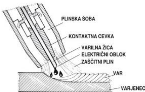
Slika 16: Varjenje po MAG postopku
