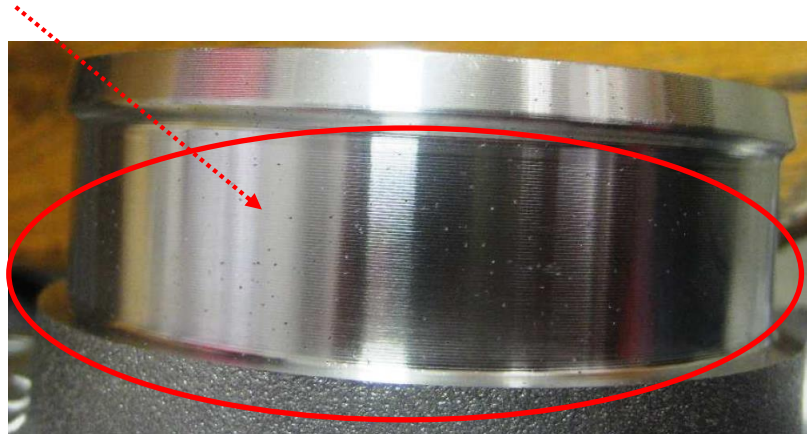
Slika 15: Mehansko obdelano ohišje turbokompresorja z vidno napako
