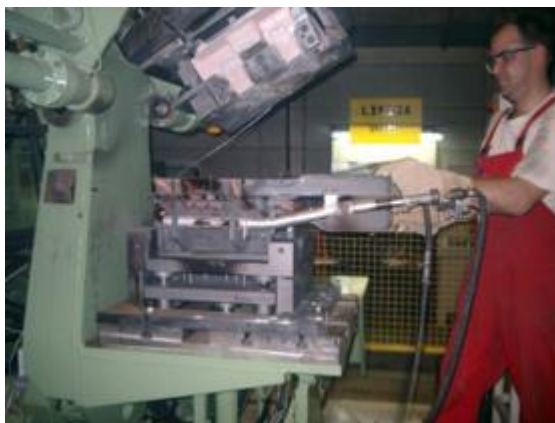
Slika 6: Ulivni stroj za gravitacijsko litje ulitkov iz Al-zlitin
