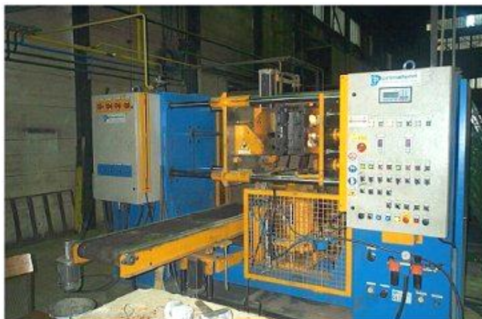
Slika 10: Stroj za izdelavo jeder Primafond SMEC25
