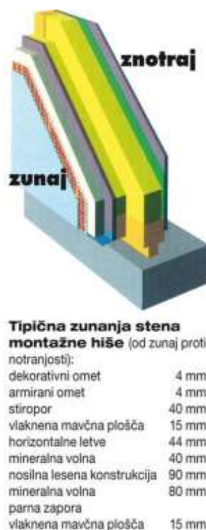
Slika 13: Prerez zunanje stene montažne hiše
