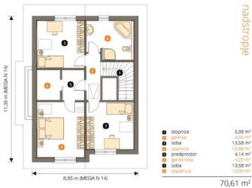
Slika 21: Tloris nadstropja hiše Orange 149
