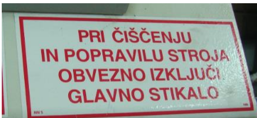
Slika 21: Primer varnostnega znaka na prebijalnem stroju
