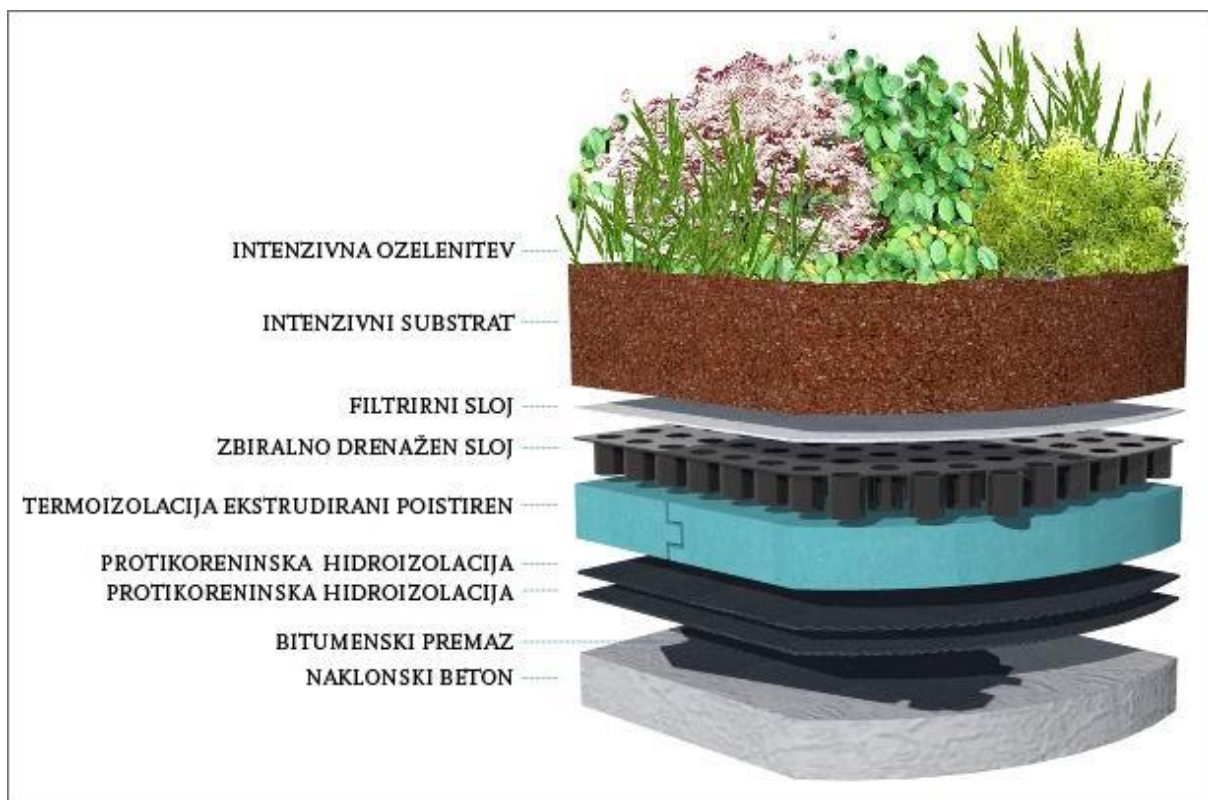
Slika 6: Prerez ravne zelene strehe z intenzivno ozelenitvijo.
