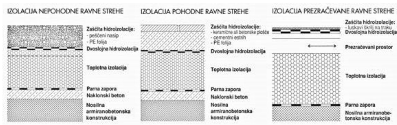
Slika 3: Detajl izolacij ravne strehe
