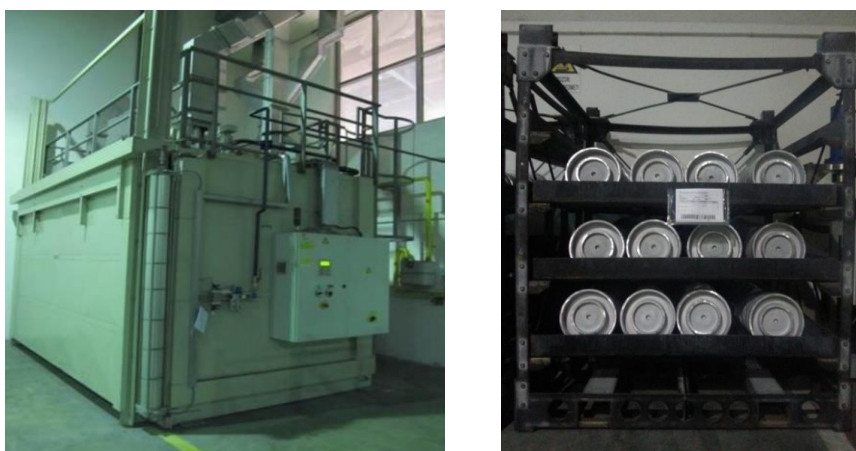
Slika 30: Peč za termično obdelavo kosov
