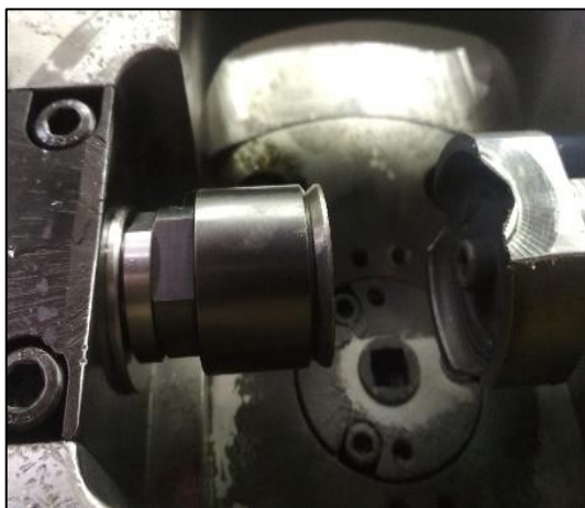
Slika 9: Vpenjalno orodje v delovni glavi
