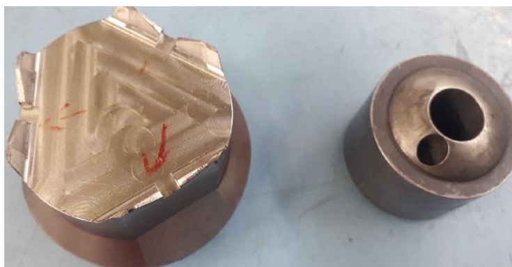
Slika 17: Novo vpenjalno orodje AAR 3700
