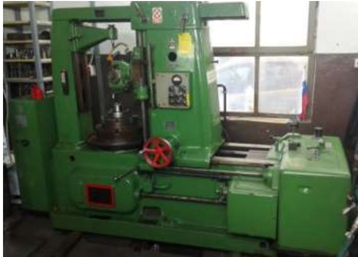
Slika 19: Stroj TOS FO-6 za izdelavo zunanega ozobljenja valjastih zobnikov po postopku odvalnega rezkanja
