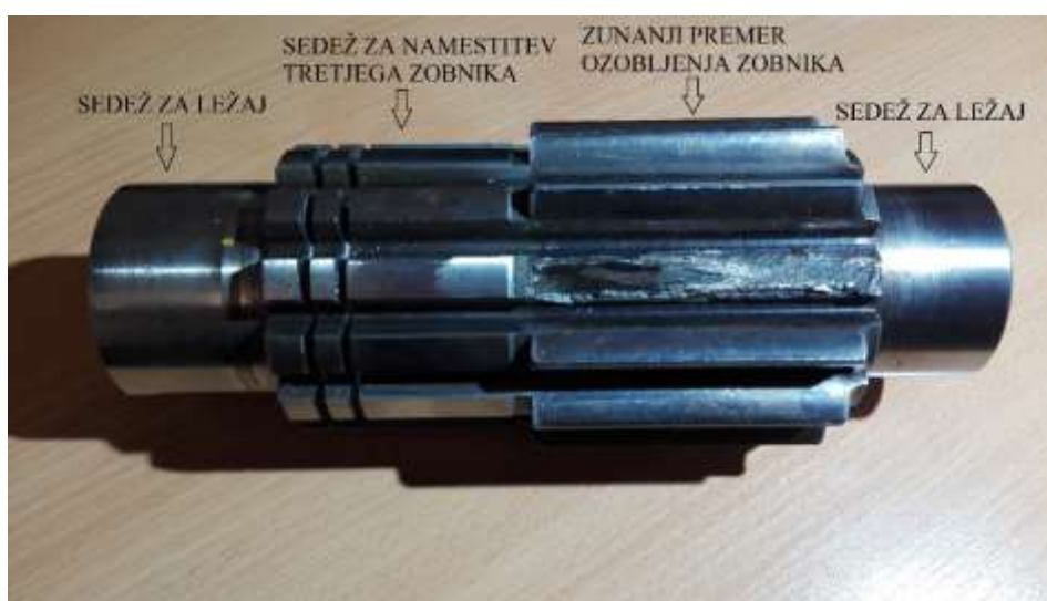
Slika 12: Tolerirane dimenzijske mere valjastega zobnika komba
