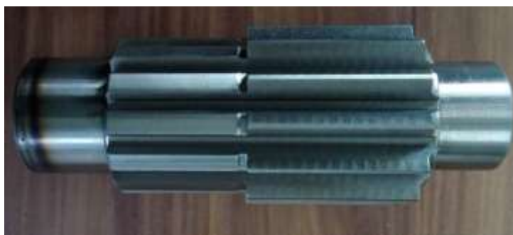
Slika 22: Valjast zobnik po končani mehanski obdelavi ozobljenja
