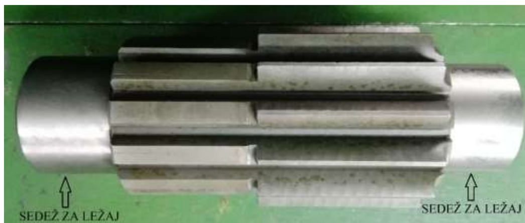
Slika 24: Valjasti zobnik po mehanski obdelavi okroglinskega brušenja sedežev za ležaje
