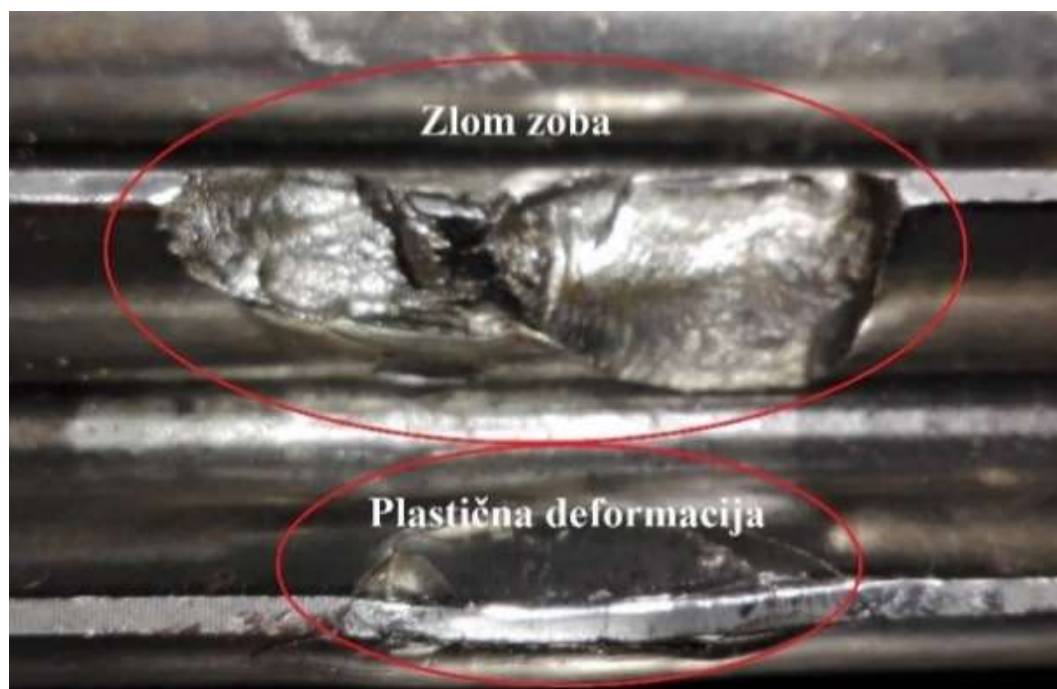
Slika 10: Zlom zoba in plastična deformacija na poškodovanem valjastem zobniku
