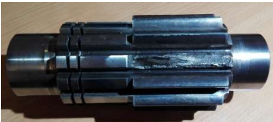
Slika 9: Poškodovani valjasti zobnik kombajna
