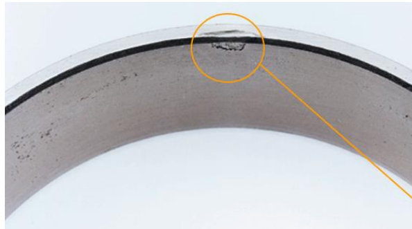
Slika 26: Poškodba neustrezne montaže
