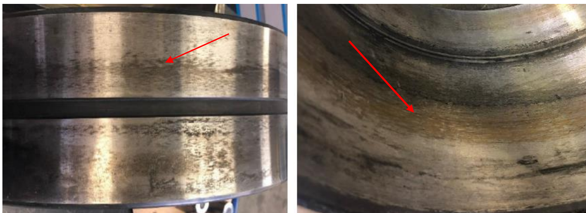
Slika 47: Sledi nastanka korozije
