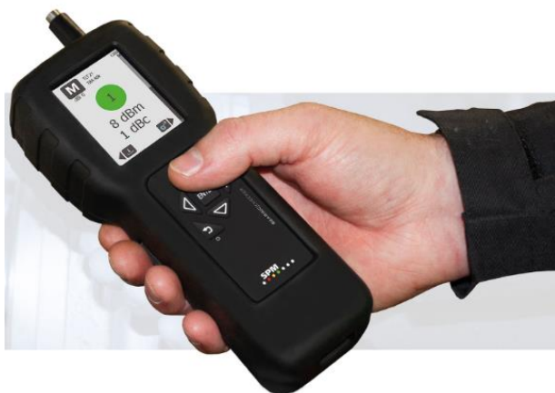
Slika 32: Naprava za merjenje stanja ležajev
