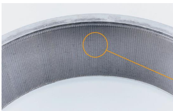
Slika 29: Poškodbe zaradi električnega toka
