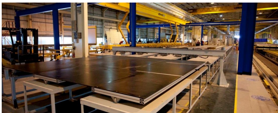
Slika 18: Izdelovanje prefabriciranih betonskih elementov v tovarni
