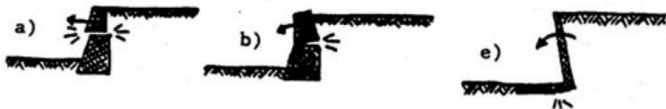
Slika 7: Možne poškodbe opornih zidov
