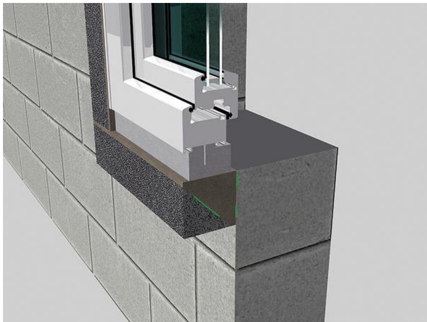
Slika 15: Montaža okna zunaj nosilnega zidu v predel toplotne izolacije
