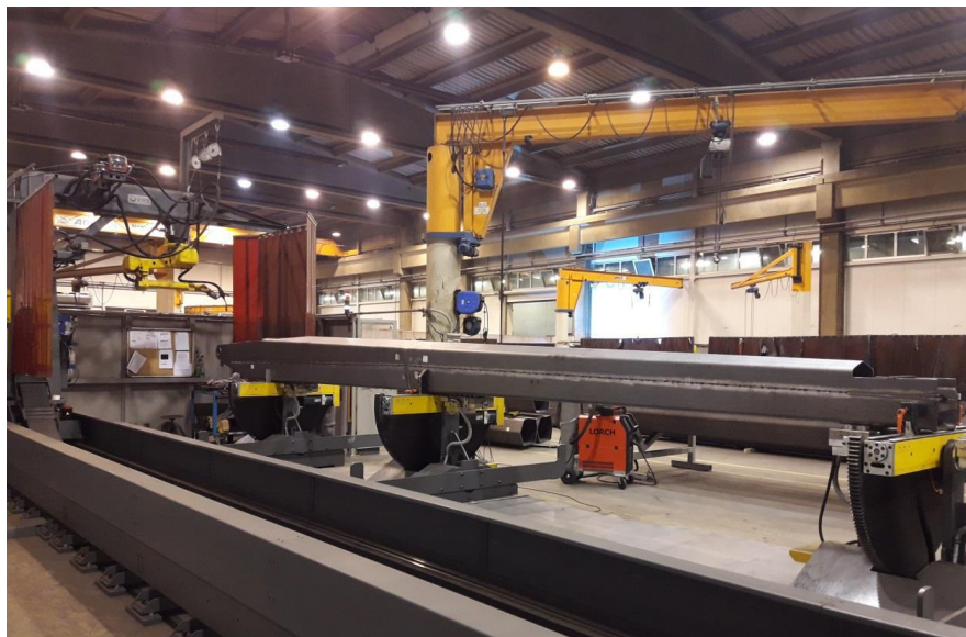
Slika 4: Obdelovanec, vpet v robotski celici
