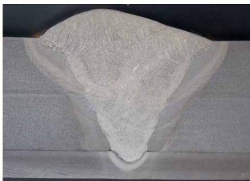
Slika 40: Makroskopska povečava (2-krat) (V-zvar)
