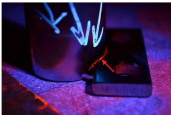
Slika 29: Pregled s tekočimi penetranti (PT)
