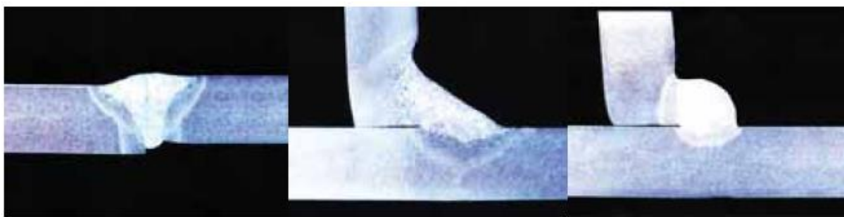
Slika 19: Oblikovne napake ( zamaknitev, zajeda, previsoko teme )
