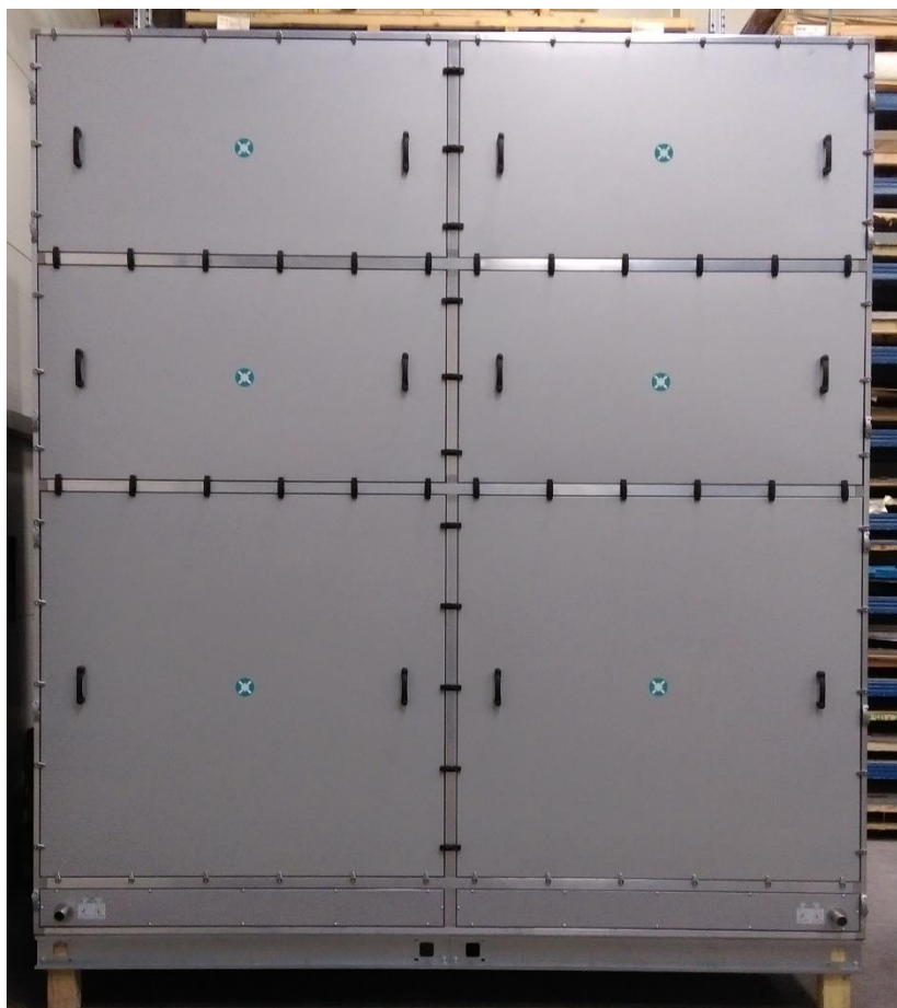
Slika 32: Primer pričvrščevanja pokrovov z blokatorji
