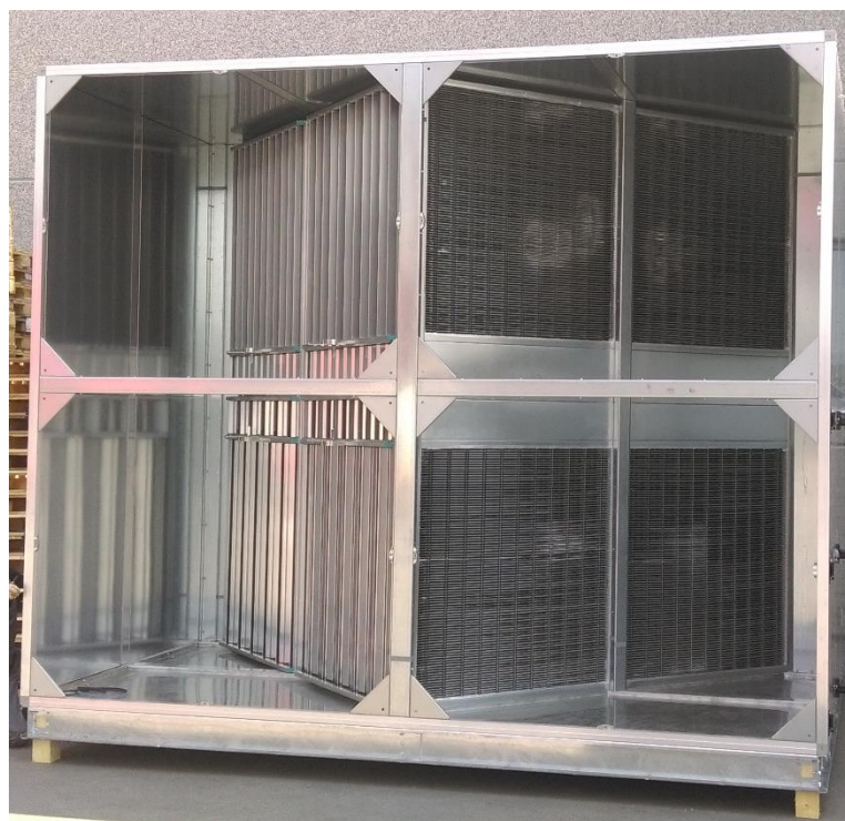
Slika 31: Vgradni in funkcijski elementi (ploščni rekuperator) v enoti
