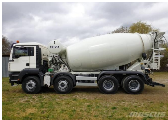
Slika 5: Prevoz betona iz betonarne na gradbišče z avtomešalcem
