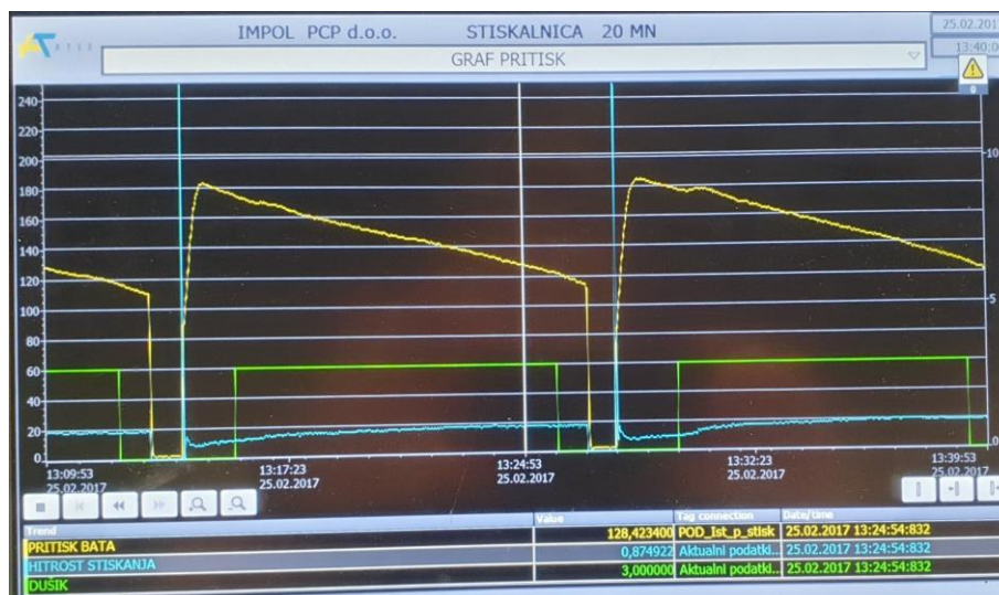
Slika 35: Slika grafa pritiska na 20 MN stiskalnici pri stiskanju palic
