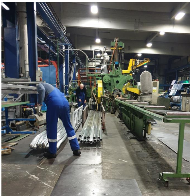
Slika 30: Nalaganje brezšivnih cevi v jeklene palete
