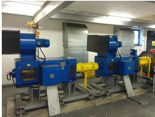
Slika 5: Elektromotorja, ki sestavljata glavni pogon KKŽ
