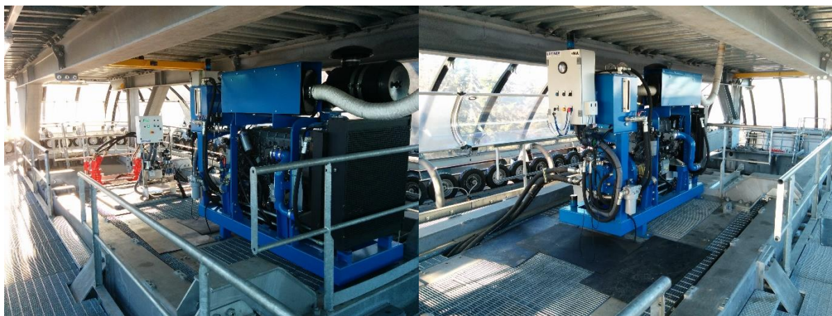
Slika 8: Hidromotorje poganja hidročrpalka, ki jo poganja dizelski agregat (zgoraj modre barve).
