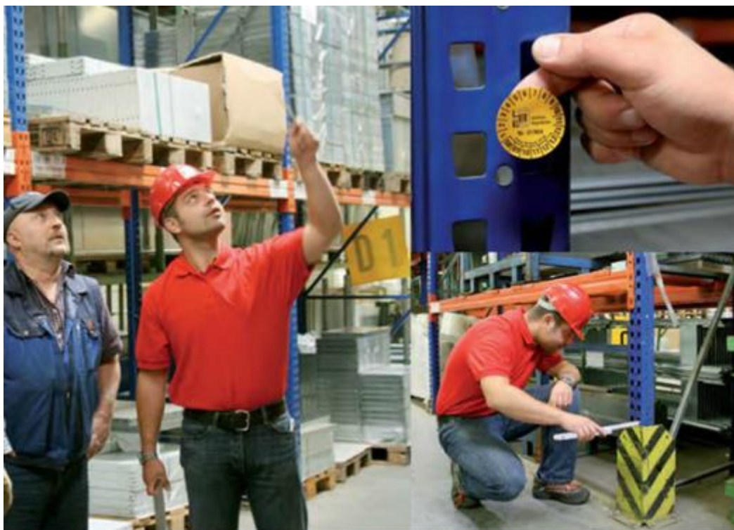
Slika 1: Strokovni pregled regalnega skladišča
