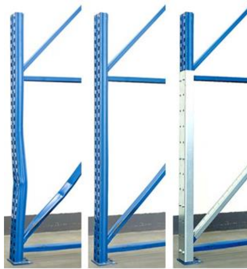
Slika 4: Popravilo regalnega elementa
