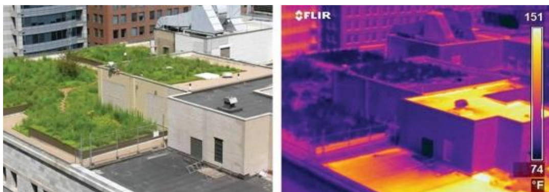
Slika 5: Toplotna slika ravne strehe, kjer je ena polovica ozelenjena, druga pa klasična bitumenska
