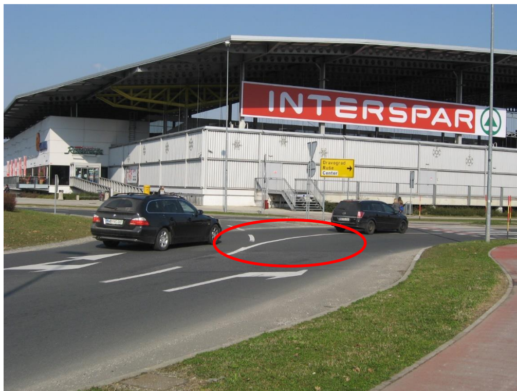
Slika 34: Polna črta, ki prekinja vozni pas in zapoveduje vožnjo v zgolj določeni smeri za vozila na zunanjem pasu..
