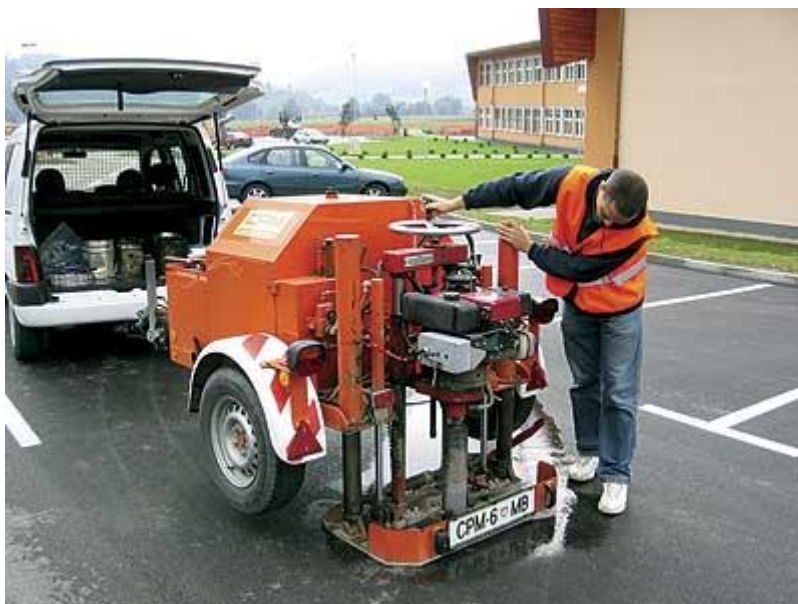
Slika 4: Odvzem vzorca asfalta
