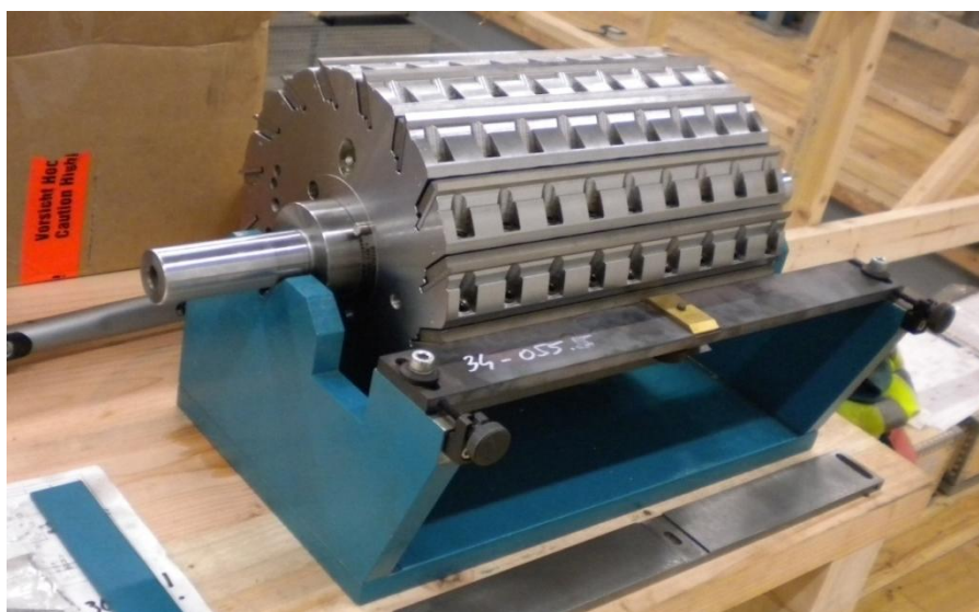
Slika 4: Primer skobeljne glave s 16 rezili
