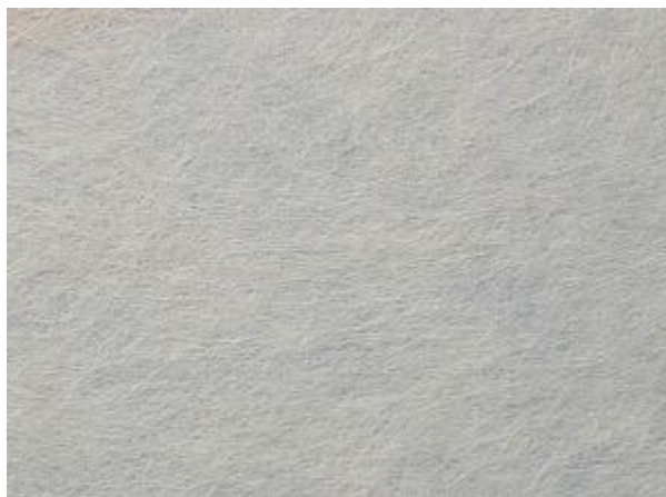
Slika 11: Težki stekleni voal kot nosilec bitumenske skodle Villas PM
