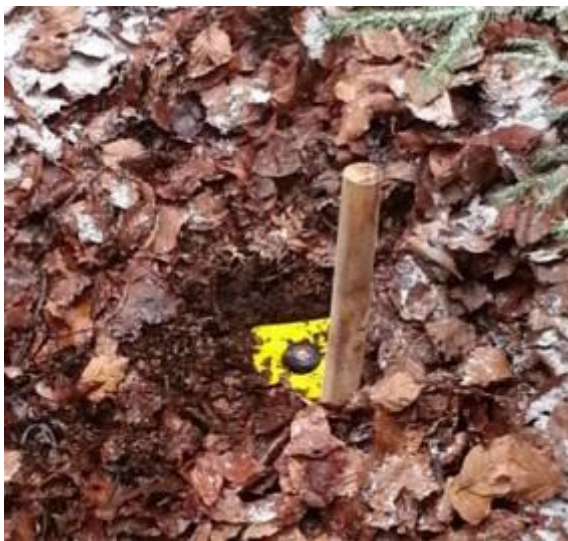
Slika 20: Mejnik s kovinskim sidrom ter betonski mejnik s križem
