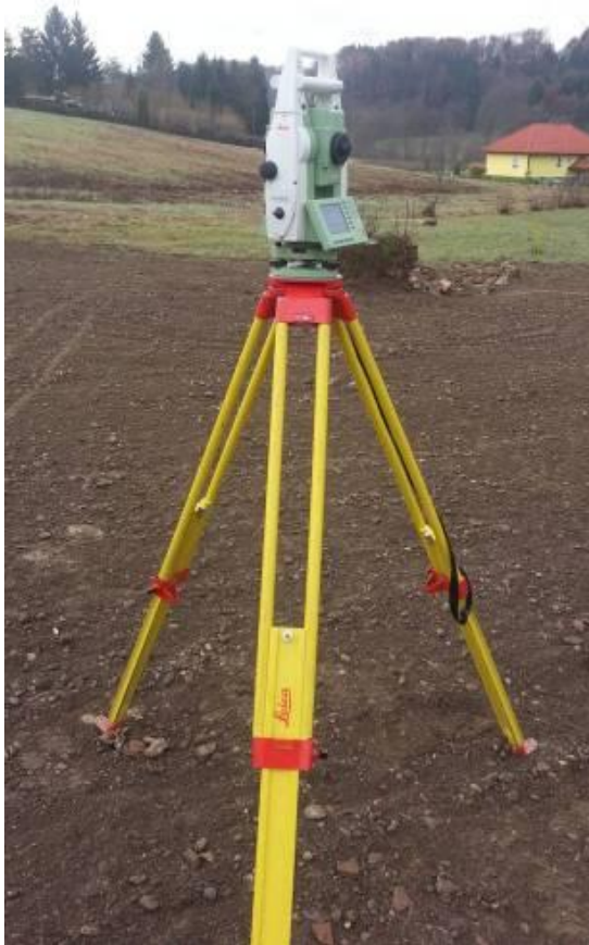
Slika 4: Leica TPS 1200+ - uporabljamo ga v podjetju, kjer sem zaposlen
