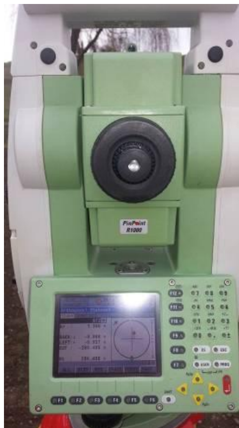
Slika 3: Tahimeter Leica TPS 1200+ - uporabljamo ga v podjetju, kjer sem zaposlen
