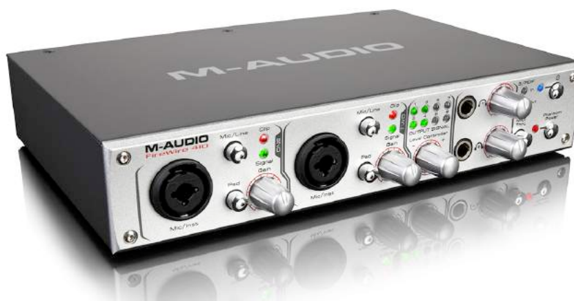
Slika 8: Zunanja zvočna kartica M-Audio Firewire 410 (Audiofanzine, 2015)
