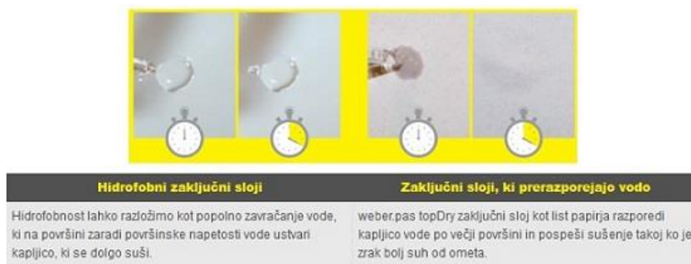
Slika 11: Kapljično sušenje na zaključnem sloju
