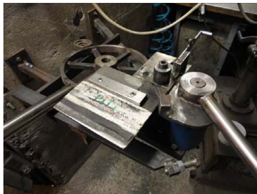
Slika 10: Priprava za krivljenje palic
