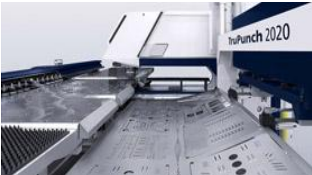
Slika 11: Avtomatska odstranitev izrezane plošče
