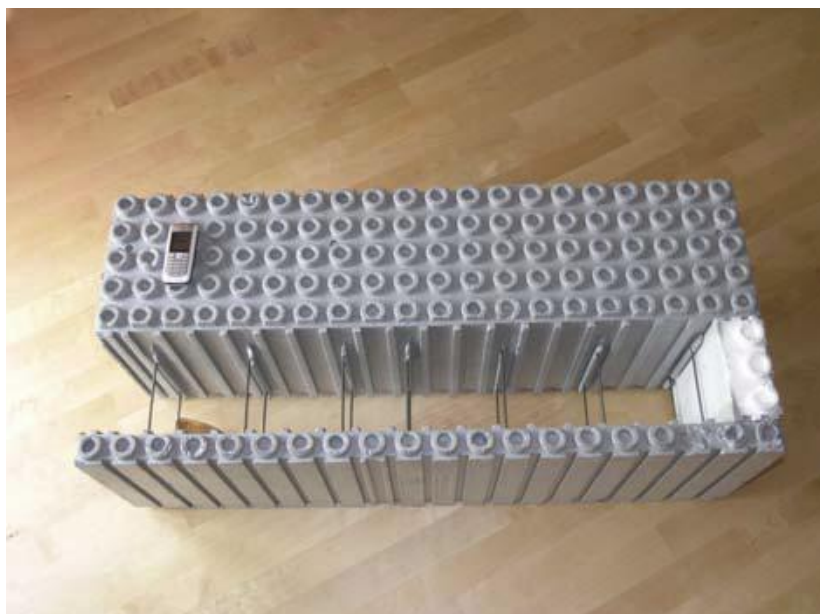
Slika 7: Zidaki iz polistirena so široki 100 cm, v odprtino se namesti armaturo in zalije z betonom (na sliki v primerjavi z velikostjo prenosnega telefona)
