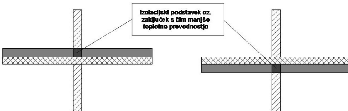
Slika 11: Izolacijski podstavek (desno) in izolacijski zaključek (levo)
