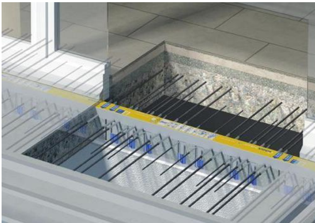
Slika 13: Toplotno izoliran, nosilni povezovalni gradbeni element za preprečevanje toplotnih mostov pri balkonih oz. previsnih konstrukcijah
