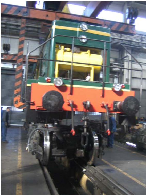
Slika 10: Uvezava lokomotive na osnovni voziček
