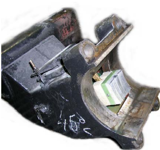
Slika 14: Vgrajena nova mazalna blazina v ohišje
